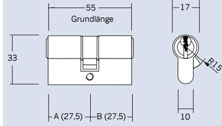
**Profil-Doppelzylinder ZRV 71 Kurzzylinder**
